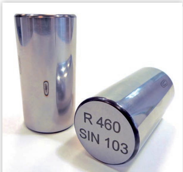
Padrão de controle da ibg com trincas e poros artificiais aplicados por eletro-erosão para simulação de defeitos abertos para a superfície, bem como regiões queimadas a laser para simulação de queima por retífica: alteração da tensão superficial (foto mais à esquerda) e início de revenimento (foto à esquerda).
