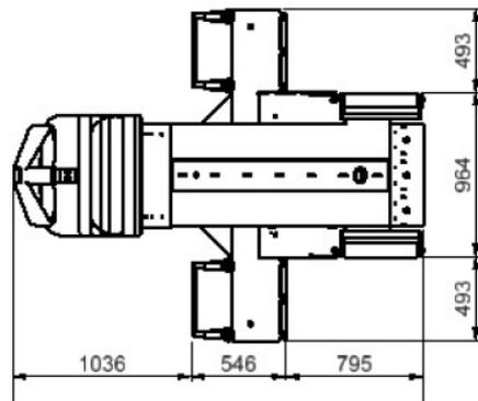
➤ Tirando partido de um chassis que se adapta às dimensões do veículo e utilizando o princípio do movimento de elevação, o Cartract é adequado para veículos bloqueados ou para quem tem pouco espaço disponível para arrumação e pretende deslocar o carro sem o ligar ou entrar nele.
